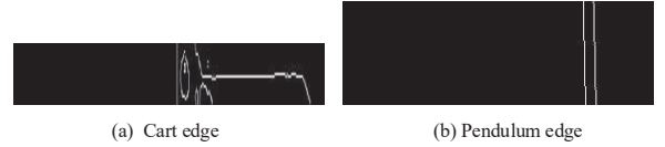
Fig. A.2. Edge detection using The Canny edge detection algorithm.
